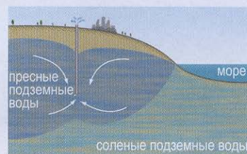
Рис. 6.33. Образование депрессионной воронки снижения подземных вод и прорыв морской воды в скважину.
