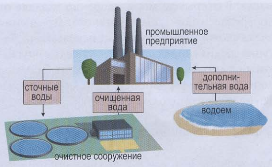
Рис. 6.35. Повторное использование воды в промышленности.
